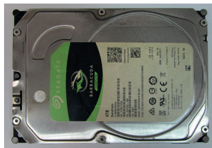
Рис. 4. Внешний вид НЖМД после очистки (вид сверху)
